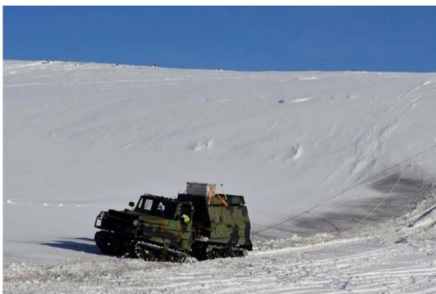
*Denne bandvogna, som forvrig ser meir militær enn sivil ut, kjørte over Finnmarksvidda og sprengte seismikk, som blei avlest av målarar som blei slepa etter. Verknadane for dyrelivet er ikkje kartlagt. (Foto: NGU)*
