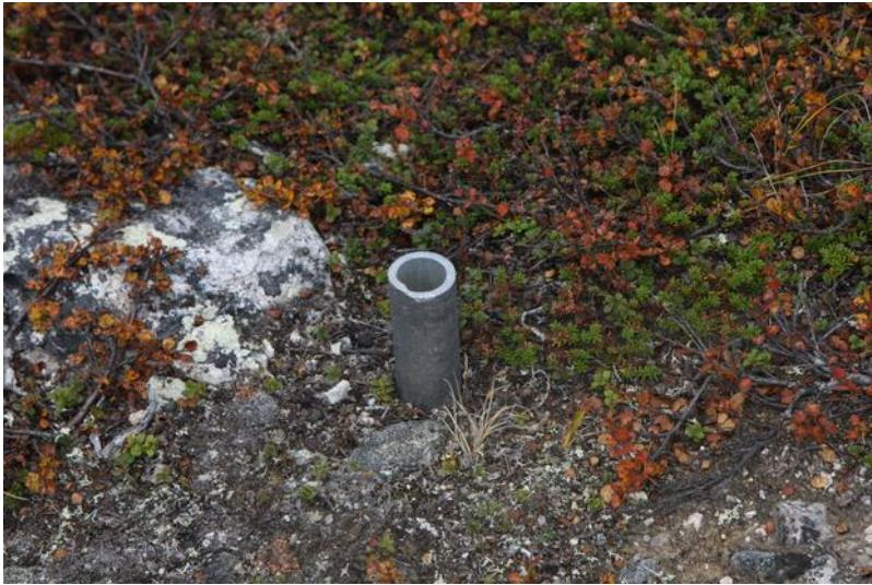
*Rør som stikk opp av bakken etter prøveboring i samband med plan om gjenoppstart av Bidjovagge Gruber. I terrenget står det framleis ei rekke slike rør, dei fleste rusta og mye høgare. (Foto: Svein Lund)*
